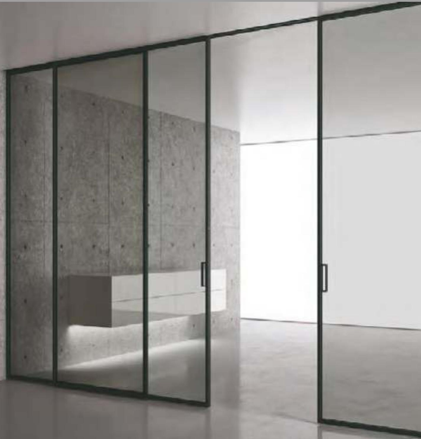
Sistema scorrevole sospeso realizzato su misura. Le ante hanno struttura in alluminio e tamponamenti sia con pannelli pieni, sia con vetri di sicurezza (temperati o stratificati). Plana System è costituito da una trave superiore scatolare estrusa in un unico profilo di alluminio, da fissare a parete o a soffitto.
