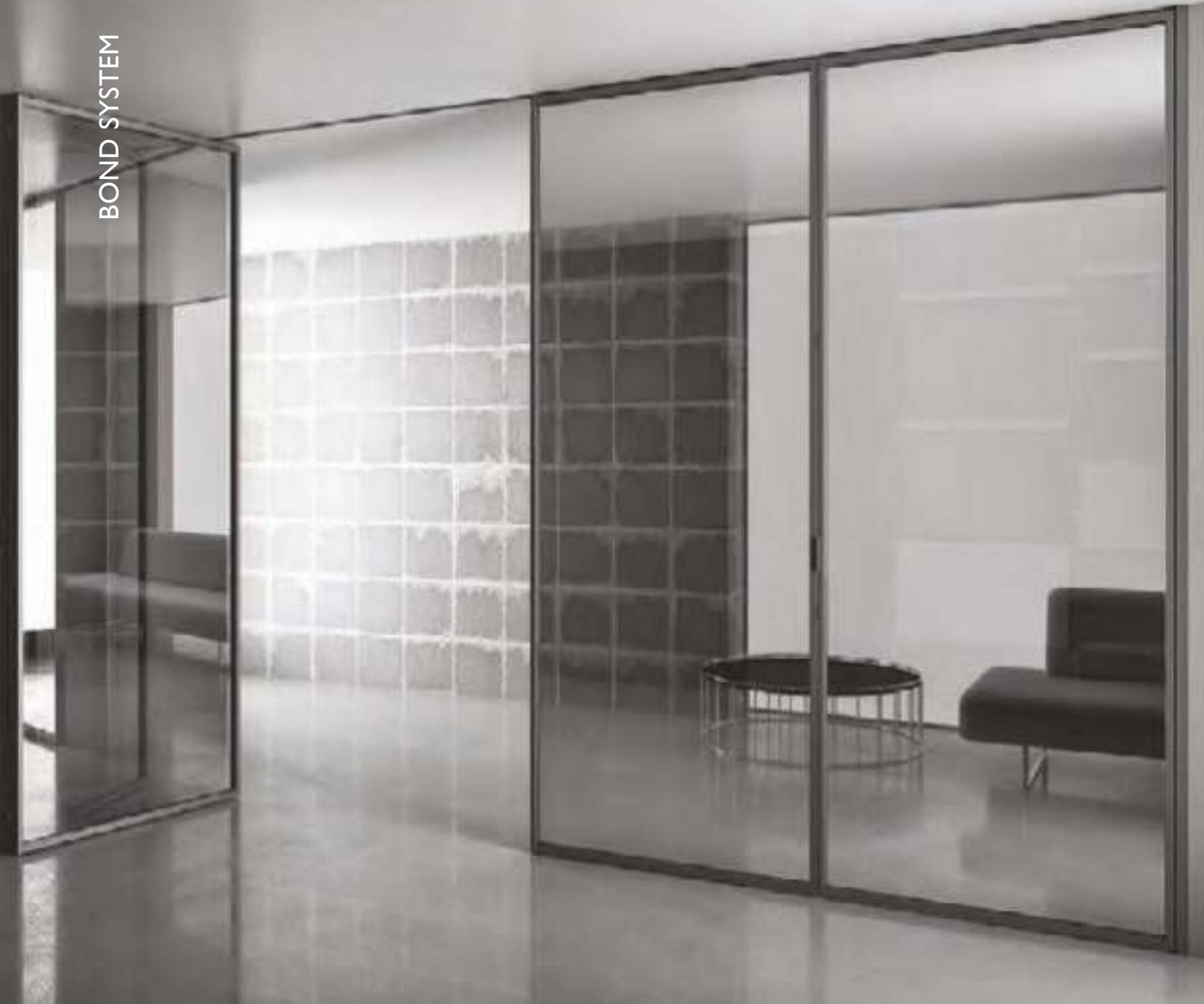
Sistema pieghevole sospeso realizzato su misura. Le ante hanno struttura in alluminio e tamponamenti sia con pannelli pieni, sia con vetri di sicurezza (temperati o stratificati). Bond System è costituito da una trave superiore scatolare estrusa in un unico profilo di alluminio da fissare a parete o a soffitto e da coppie di ante pieghevoli.
