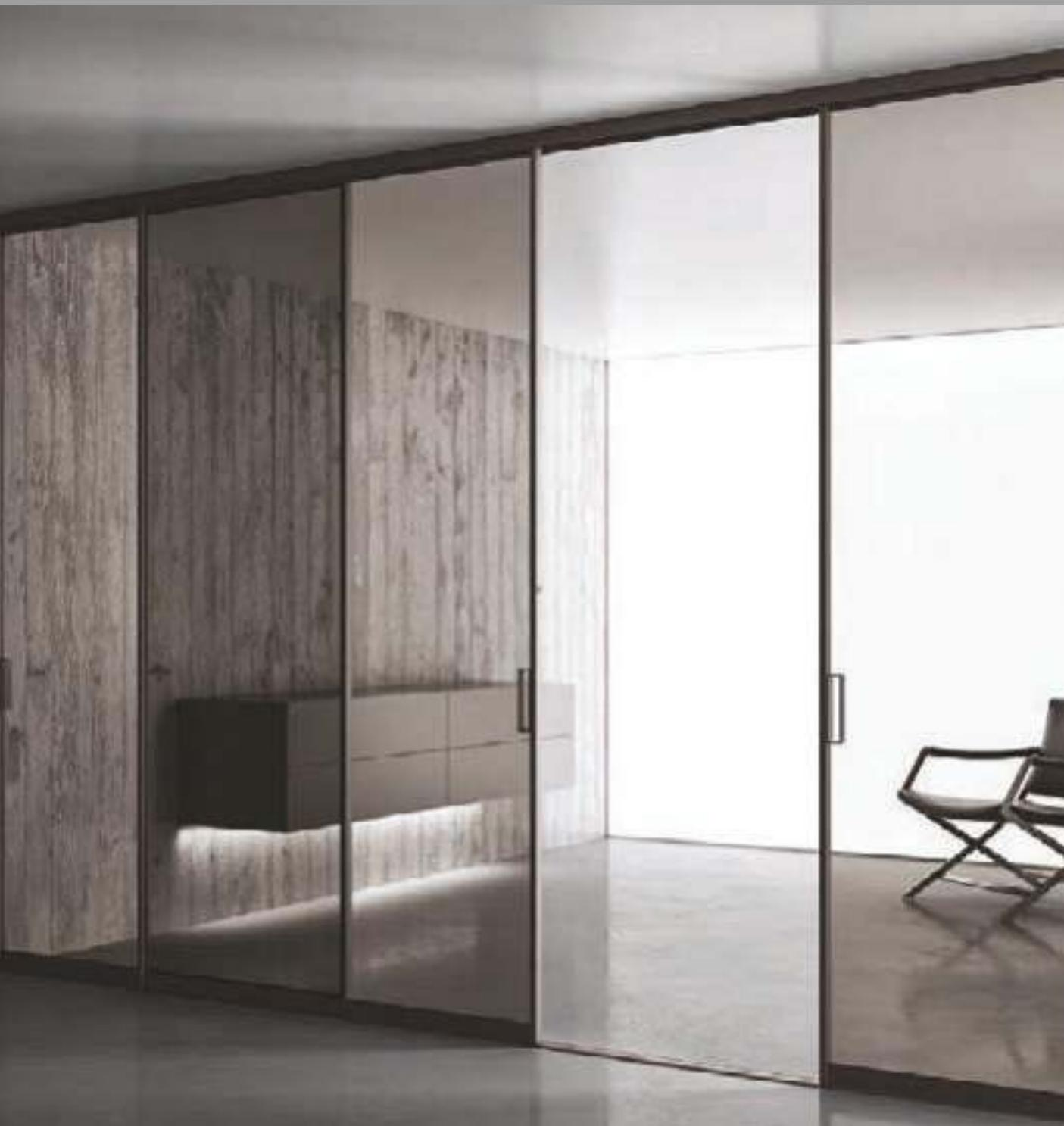
Sistema scorrevole sospeso con binario a terra, realizzato su misura. Le ante hanno struttura in alluminio e tamponamenti sia con pannelli pieni, sia con vetri di sicurezza (temperati o stratificati). Rolling System è costituito da una trave superiore scatolare estrusa in un unico profilo di alluminio, da fissare a parete o a soffitto e presenta un binario guida a terra.
